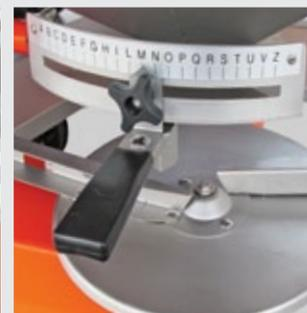
Index gradués se référant aux tableaux d'épandage pour une fumure de grande précision
