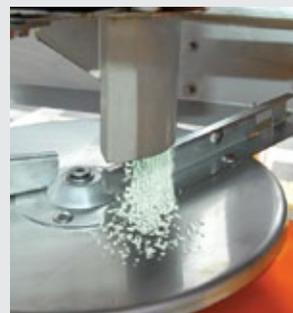
Réglage de la chute de l'engrais sur le disque d'épandage
