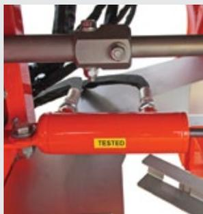
Commande hydraulique pour l'ouverture et la fermeture des sorties de l'engrais
